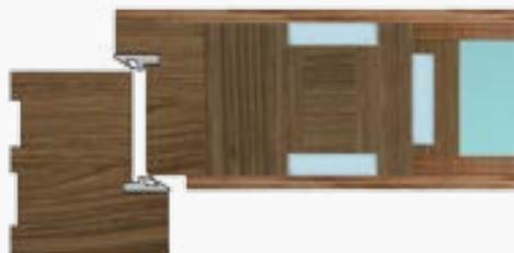
Querschnitt der Tür 82 mm mit einem Verbundprofil
