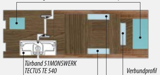
Wärmedämmung aus einem wärmedämmenden Spezialschaum
